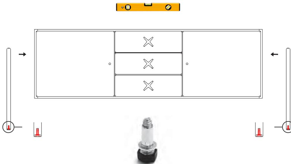
1. Avvitare le gambe laterali al mobile tramite i perni già posizionati.
