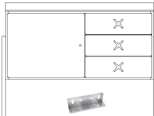
**3.** Riportare a parete i punti di posizionamento delle piastre per attaccaglia, scostare il mobile e fissare a muro le piastre mediante viti e tasselli a seconda della tipologia della parete. Riaccostare il mobile a parete e agganciare le attaccaglie alle piastre.
