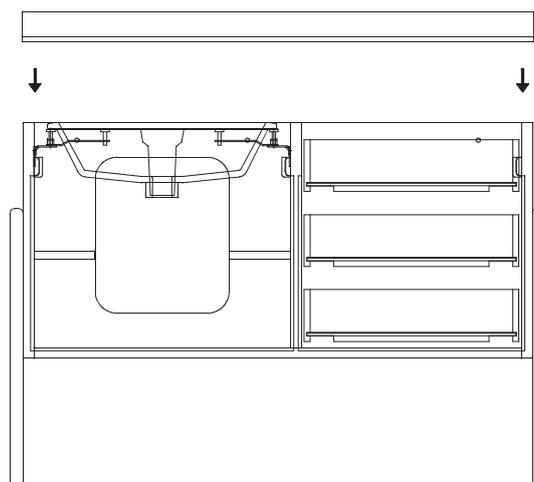
**6.** Posizionare il lavabo ceramico sulle viti di supporto regolando l'altezza in linea con il bordo superiore del mobile.
