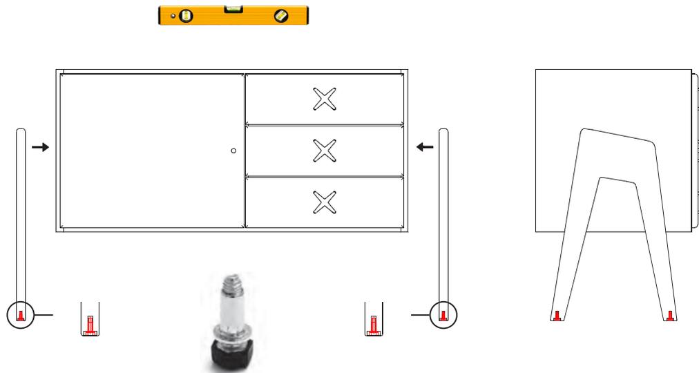
**1.** Avvitare le gambe laterali al mobile tramite i perni già posizionati.
