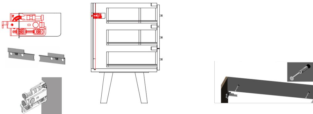
**3.** Riportare a parete i punti di posizionamento delle piastre per attaccaglia, scostare il mobile e fissare a muro le piastre mediante viti e tasselli a seconda della tipologia della parete. Riaccostare il mobile a parete e agganciare le attaccaglie alle piastre.
